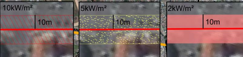
O jato de fogo e radiação térmica para os vazamentos com carga de 10kW/m², 5kW/m² e 2kW/m² atingiram a distância igual de 10m
