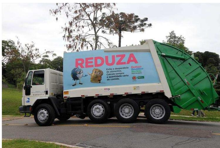
Figura 5: Caminhão compactador com 4º eixo
