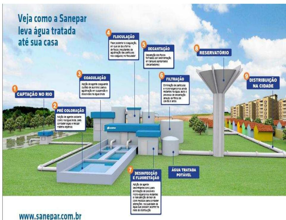
**Figura 2:** Representação esquemática do sistema de tratamento de água.
