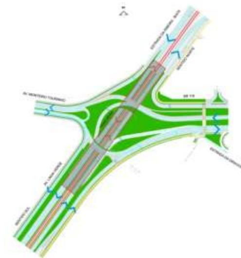
Figura 27 – Transposição em desnível no entroncamento da Av. Linha Verde com a rodovia BR-116
