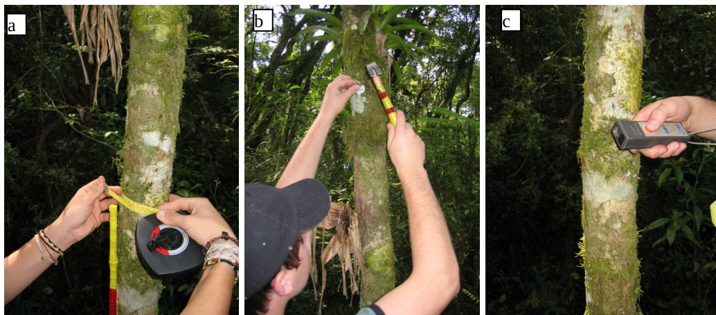
Figura 3: a) Mensuração do perímetro a 1,3m do solo (PAP); b) Identificação dos indivíduos com plaqueta numerada; c) Utilização de aparelho para mensuração de distância das árvores ao centro da parcela.
